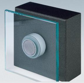
GM PICO KING® wurde von Glas Marte speziell für die einfache und rationelle Befestigung im Innenbereich entwickelt. Zur Montage sämtlicher Plattenmaterialien (8–12 mm Stärke) können beliebige Senkkopfschrauben mit einem Durchmesser von 6 mm verwendet werden.
