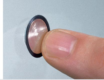
GM PICO® wurde von Glas Marte speziell für die einfache und rationelle Befestigung im Innenbereich entwickelt. Zur Montage sämtlicher Plattenmaterialien (6–8 mm bzw. 10–12 mm Stärke) können beliebige Senkkopfschrauben mit einem Durchmesser von 6 mm verwendet werden. Die weiche Auflagescheibe hält das zu befestigende Element auf Distanz zur Unterkonstruktion. GM PICO® kann auch als Distanzhalter für den Transport genutzt werden.
