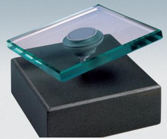
GM PICO LORD® wurde von Glas Marte speziell für die einfache und rationelle Befestigung im Innenbereich entwickelt. Zur Montage sämtlicher Plattenmaterialien (8–12 mm Stärke) können Stockschrauben oder Gewindestifte mit einem Durchmesser von 6 mm verwendet werden.
